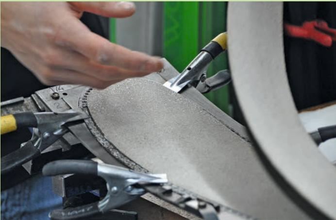
Anschliessend wird das Sandwich zusammengebaut und bei hoher Temperatur und grossem Gewicht gepresst.
