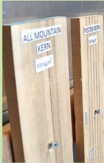
Ein Ski besteht aus verschiedenen Materialien (links). Je nach Ski wird ein unterschiedlicher Holzkern verwendet (rechts).
