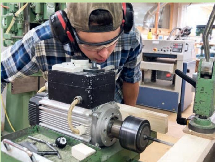
Präzises Arbeiten mit der Langlochbohrmaschine.
