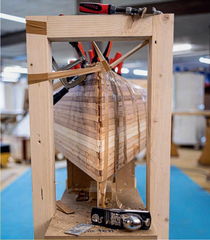
**Oberes Bild:** Für das Trocknen des Leims war ein temporärer Rahmen nötig, weil die Spannung stark zunahm, je näher Joe Chun der Wasserlinie des Kanus kam.
