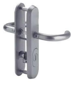
Einen niederschweligen Einbruchschutz bieten Langschilder mit durchgehender Verschraubung. Allerdings funktionieren sie nur, wenn angriffsseitig keine Schrauben sichtbar sind (Verschraubung in auf der Rückseite aufgeschweisste Gewindehülsen).
