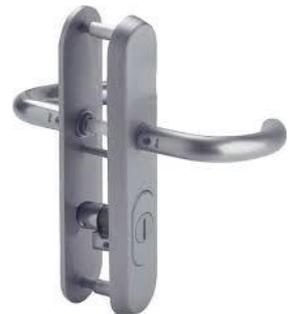
Le cartelle lunghe con collegamento a vite passante offrono una protezione antieffrazione a bassa soglia. Tuttavia, funzionano solo se non ci sono viti visibili sul lato dell'aggressione (avvitamento su boccole filettate saldate sul retro).
